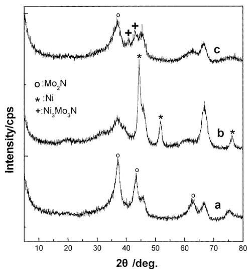
Fig. 1. XRD patterns of: (a)  $Mo_2N/\gamma-Al_2O_3$ ; (b)  $NiN_x/\gamma-Al_2O_3$ ; (c)  $NiMoN_x/\gamma-Al_2O_3$ .
