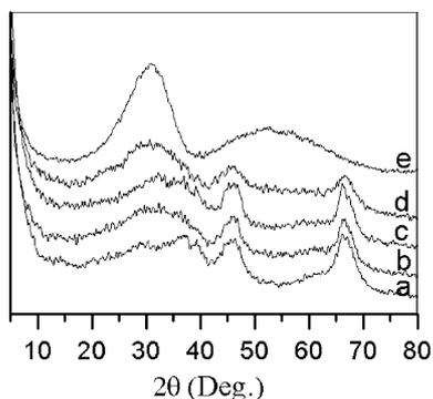
Fig. 1. XRD patterns of: (a)  $\text{Al}_2\text{O}_3$ , (b) ZA05, (c) ZA10, (d) ZA20, and (e) amorphous  $\text{ZrO}_2$ .
